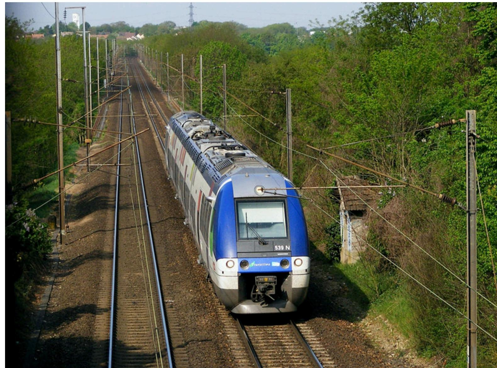
Trilport - 20 avril 2011 - Entre Meaux et Trilport, les AGC circulent en traction électrique. Durant l'arrêt, le conducteur abaisse le pantographe et poursuit son trajet en traction thermique. © transportrail
